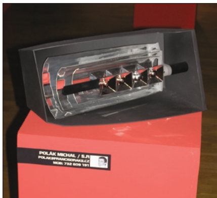
Obr. 2. Principiální model světlometu podle obr. 1
